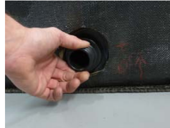
Inliner durch den Wassercontainer führen
