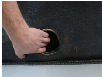
Inliner durch den Wassercontainer führen
